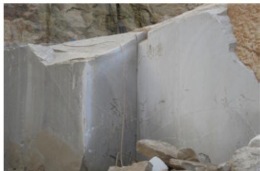
Realização de um corte de levante com fio diamantado e aspecto das superfícies obtidas com esta técnica.
