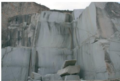
O fio diamantado permite a execução de cortes em grandes áreas com o mínimo desperdício de rocha.
