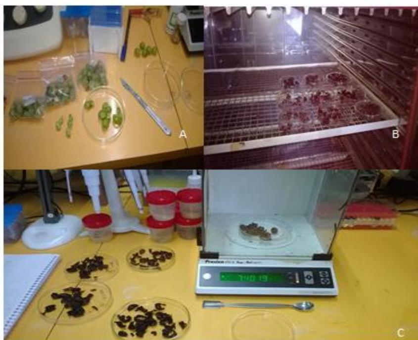
**Figura 25-** Processo de obtenção do extrato (A-Descaroçamento das azeitonas; B-Secagem em estufa; C-pesagem das azeitonas secas)
