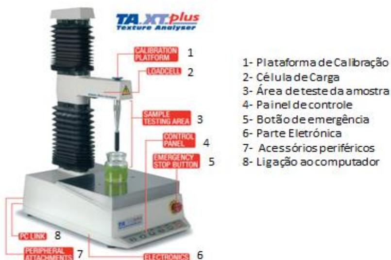
**Figura 21** – TA.XT PLUS (Texture Analyser). (Fonte:
