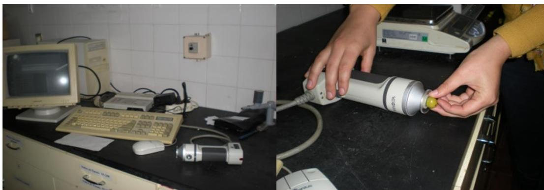
**Figura 21-** Determinação da cor, pelo sistema de coordenadas "Hunter-Lab".
