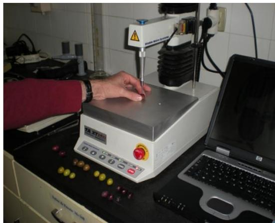
**Figura 22-** Determinação da textura, pelo texturómetro (modelo TA.XT).
