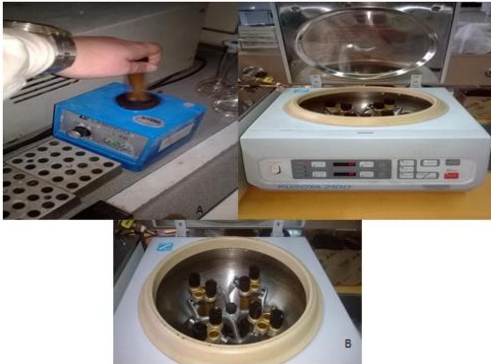
**Figura 27-** Preparação do extrato: (A- Agitação no vortéx; B- Amostras na centrífuga)
