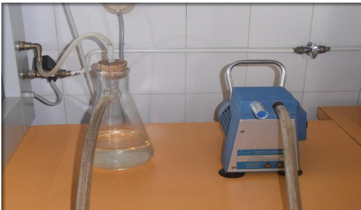
**Figura 9 - Kitasato e bomba de vácuo utilizados na filtração. (Fonte: Autor)**
