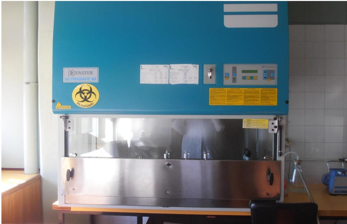
**Figura 8 - Câmara de fluxo laminar utilizada na Técnica Membrana Filtrante. (Fonte: Autor).**
