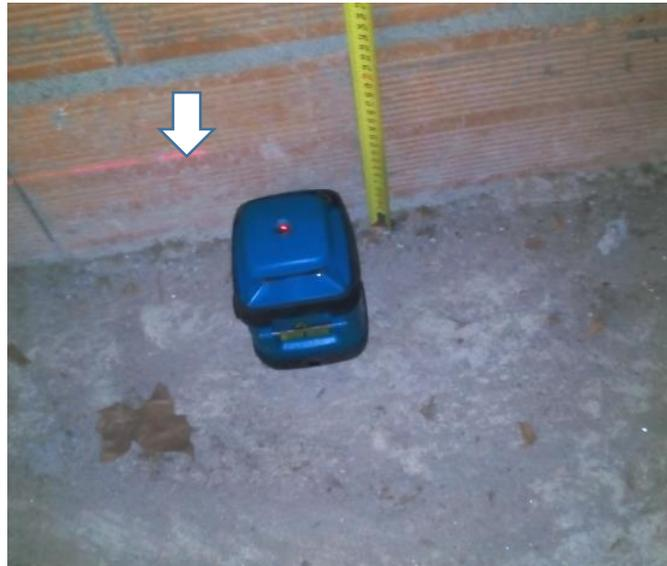
Figura 38 - Aparelho de nivelamento
