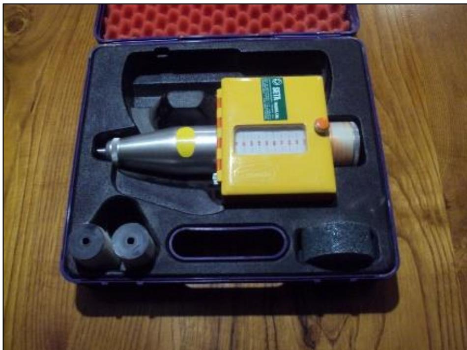
*Figura 55 - Caixa Esclerômetro com todos utensílios*
