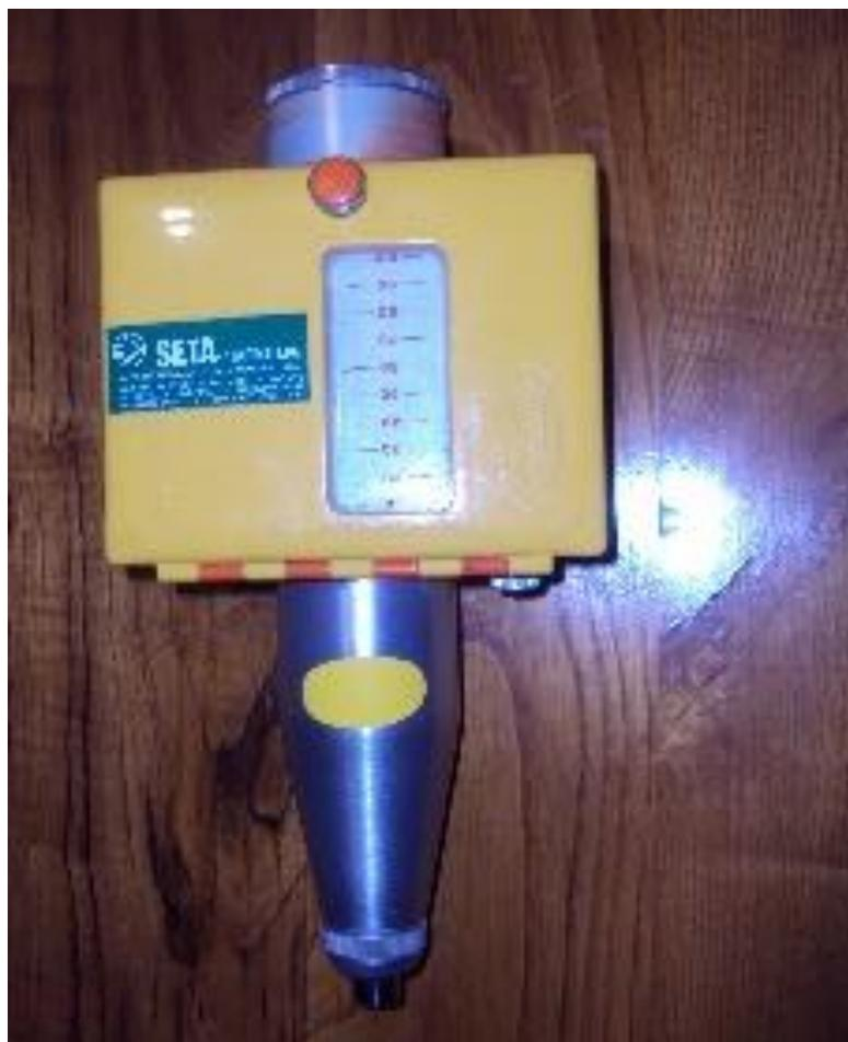
*Figura 10 - Esclerómetro*
