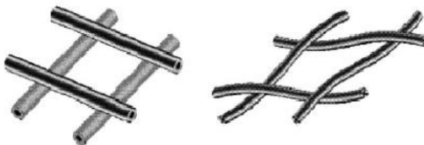
**Figura 2.4** - Formas básicas de redes comerciais de espaçadores (Ghidossi *et al.*, 2006).
