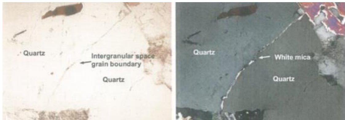
Figura 21 - Mica branca a preencher o espaço intergranular entre dois cristais de quartzo (FONTE: LGA136-182-EN)
