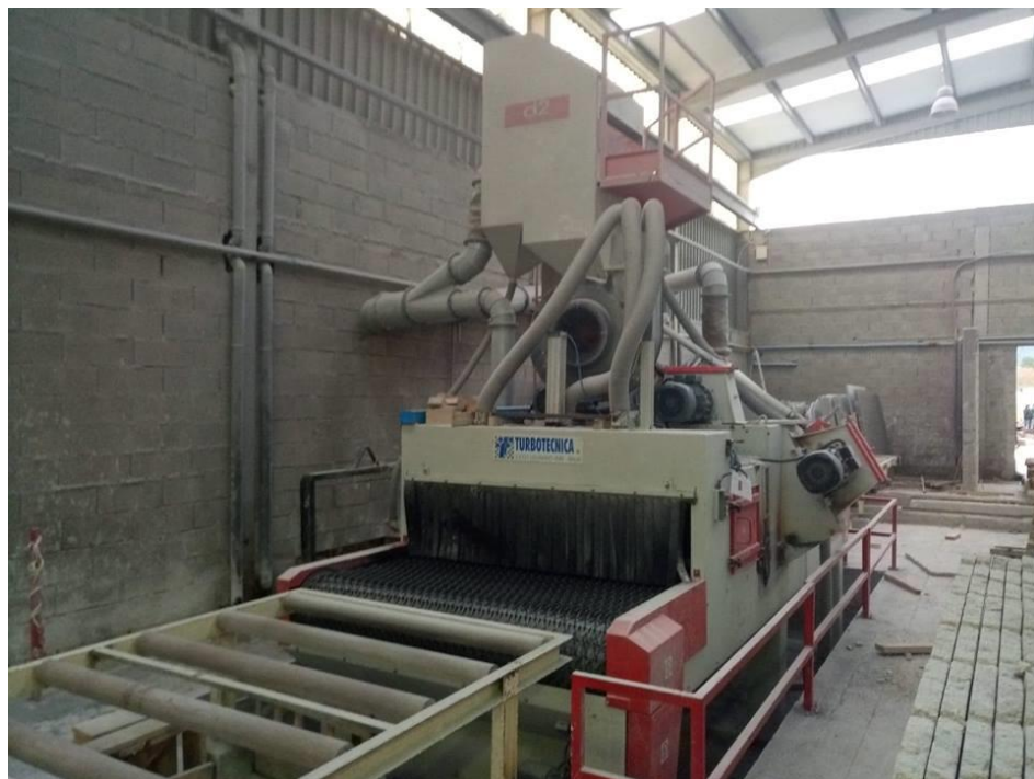
Figura 16 – Granalhadora de Granito (Fotografia do Autor)
