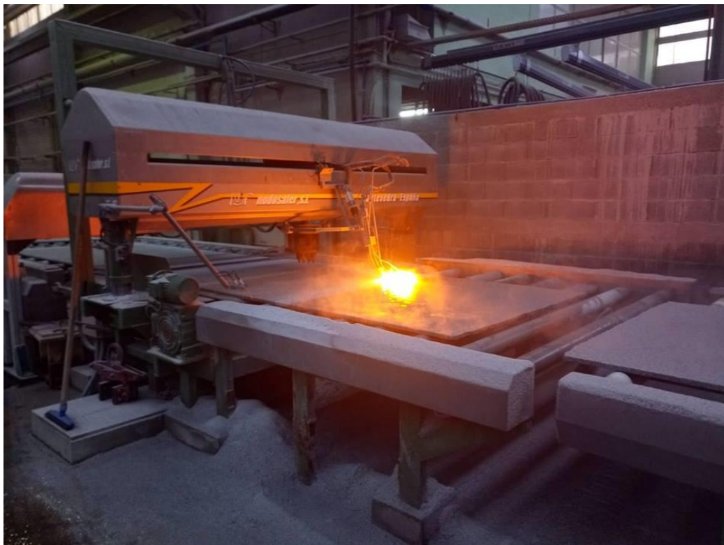
Figura 15 – Flamejadora de Granito (Fotografia do Autor)
