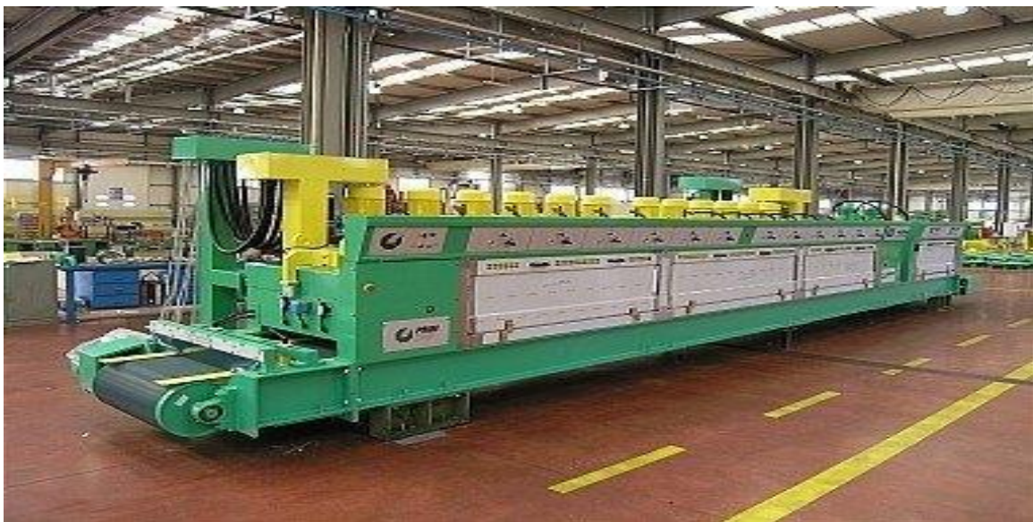
Figura 14 – Polidora de Granito (Internet 7)
