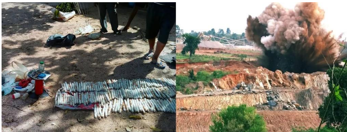
Figura 11 - Extração com explosivos em pedreiras (Internet 6)
