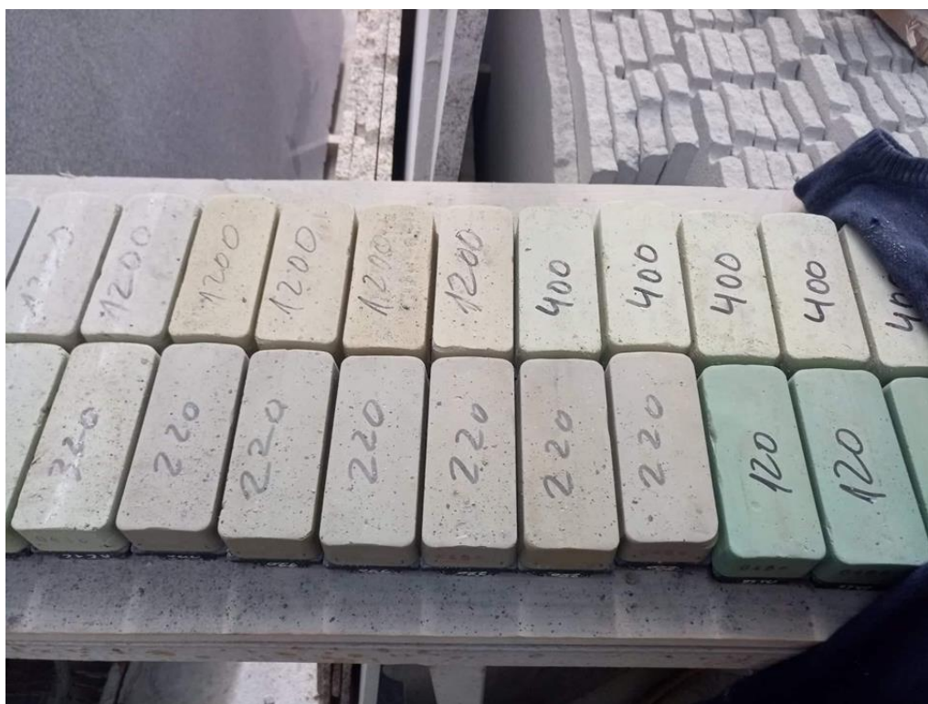
Figura 13 – Abrasivos utilizados no polimento e amaciamento de rochas (Fotografia do Autor)
