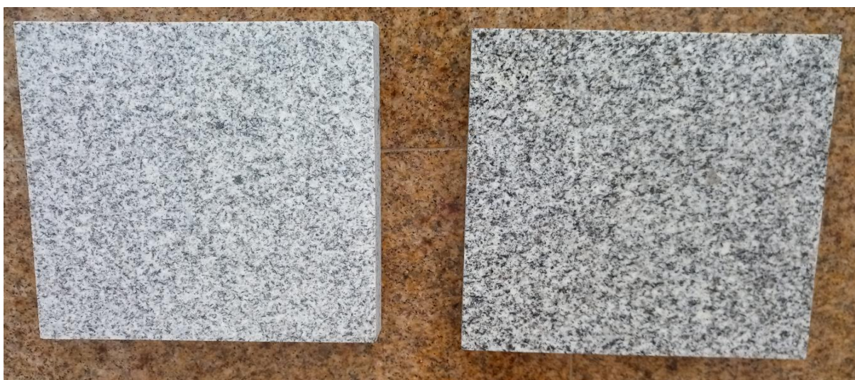
Figura 27 – Amostra Amaciada seca (á esquerda) e molhada (á direita)
