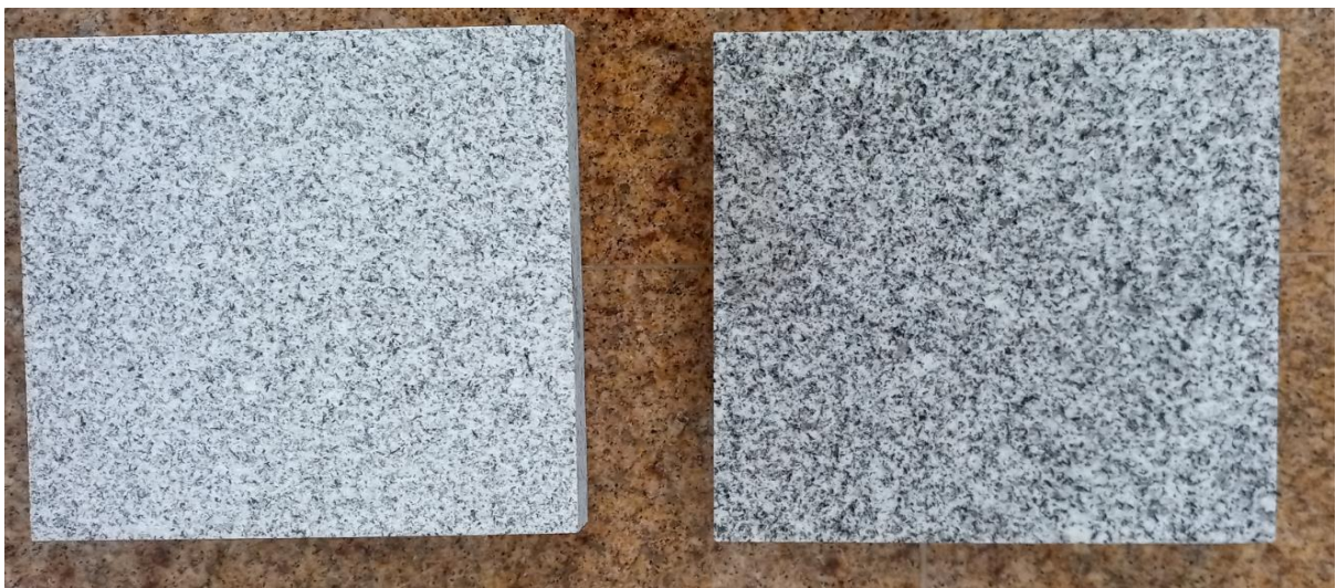
Figura 29 – Amostra Flamejada seca (á esquerda) e molhada (á direita)
