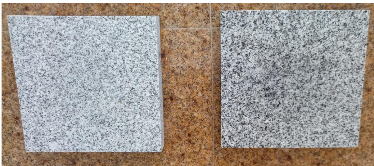
Figura 26 – Amostra Polida seca (á esquerda) e molhada (á direita)
