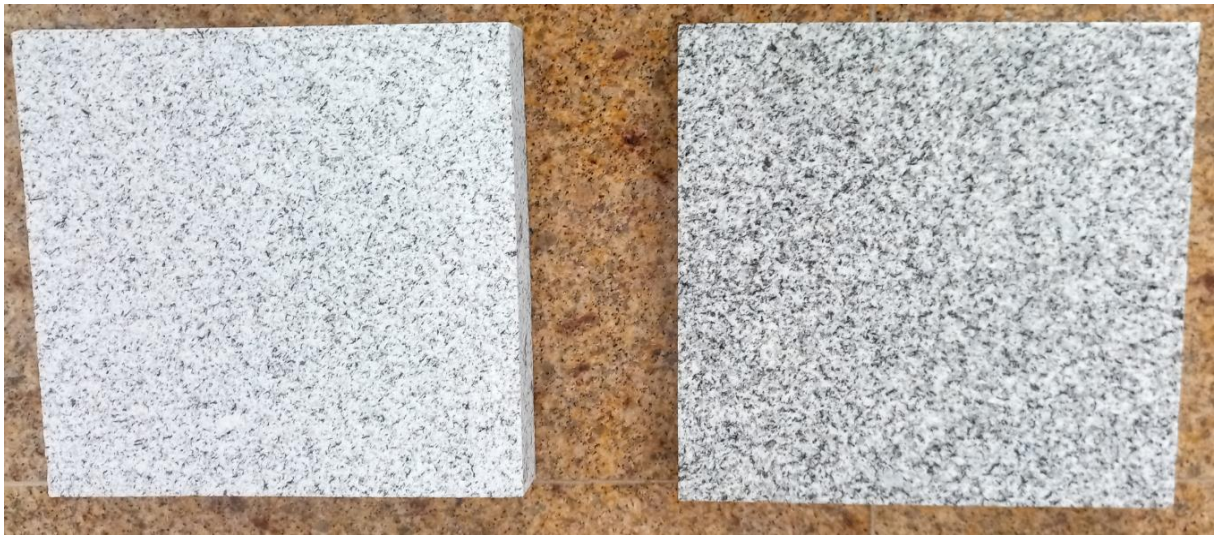
Figura 28 - Amostra Granalhada seca (á esquerda) e molhada (á direita)
