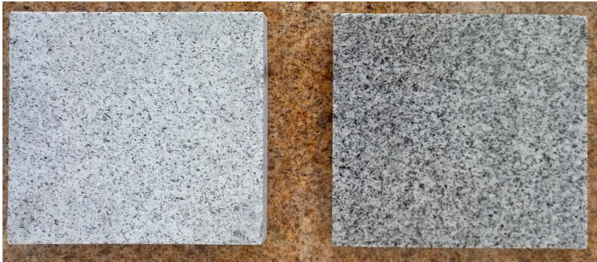
Figura 30 – Amostra Serrada seca (à esquerda) e molhada (à direita)
