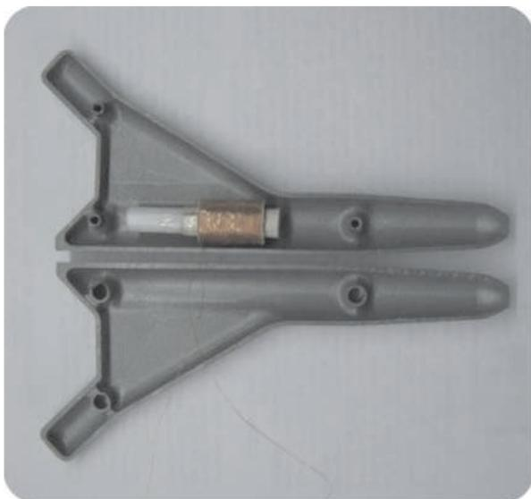
**Figura 6.2** – Um dos primeiros protótipos do gerador electromagnético.
