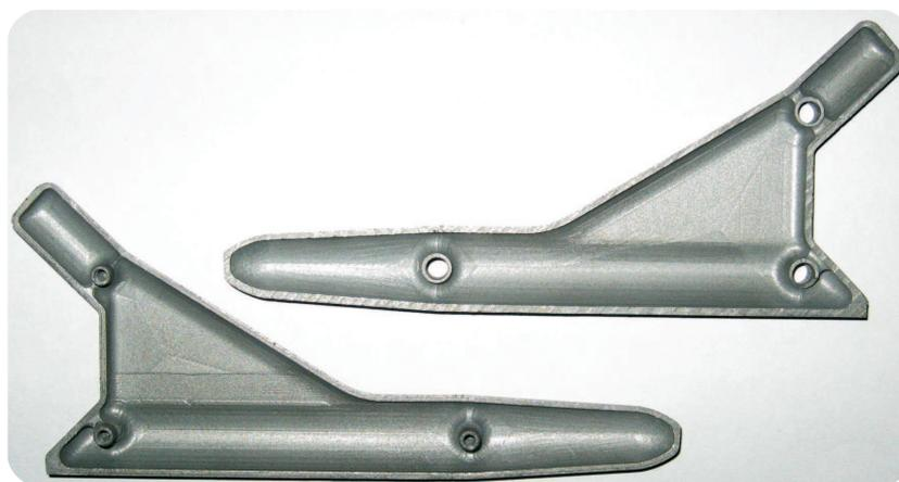
Figura 2.7 – Modelo de prótese de anca em corte transversal realizada em prototipagem rápida no Departamento de Engenharia Mecânica da Universidade de Aveiro.
