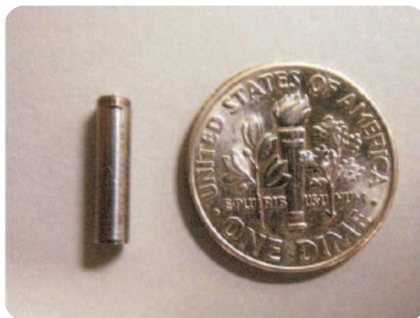
**Figura 1.11** – Dimensões da bateria QL0003I da Quallion.
