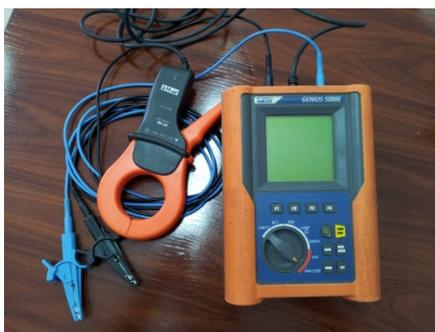
Figura 2-1 Analisador de energia monofásico
