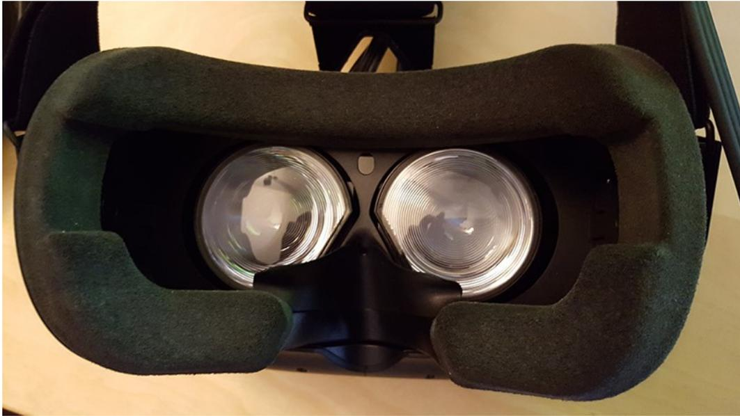
Figura 3 Parte interior com as óticas visíveis dos HMD HTC Vive
