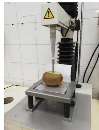
Figura 21- Analisador de textura TAXT Plus (Stable Micro Systems). Fonte: Fotografia de autor.
