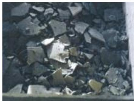
**Figura 17 - Lama após desidratação no Filtro de Prensa**
