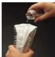
**Passo 2:** Despeje no Quanti-Tray (contagem de 1 a 200) ou no Quanti-Tray/2000 (contagem de 1 a 2419).
