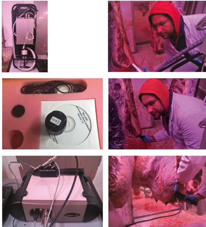
**Figura 13.** Ilustração de três sistemas NIRS a serem testados num ensaio piloto num matadouro de bovinos (Maltin *et al.*, 2015).
