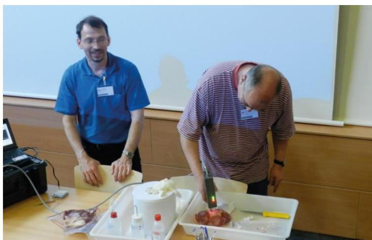
**Figura 15.** Demonstração da técnica de Raman num sistema portátil com aplicação direta numa amostra de carne (Maltin *et al.*, 2015).
