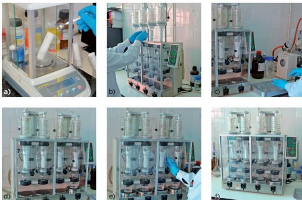
**Figura 11** - Procedimento para análise do teor de gordura utilizando o equipamento automático Soxhlet. **a-** amostra; **b-** colocação da amostra no equipamento; **c-** introdução dos tubos e preparação do éter de petróleo; **d-** introdução da extração com o éter de petróleo ao equipamento; **e-** abertura da conexão para permitir a recirculação do éter de petróleo; **f-** processo de extração. (Silva *et al.*, 2015).
