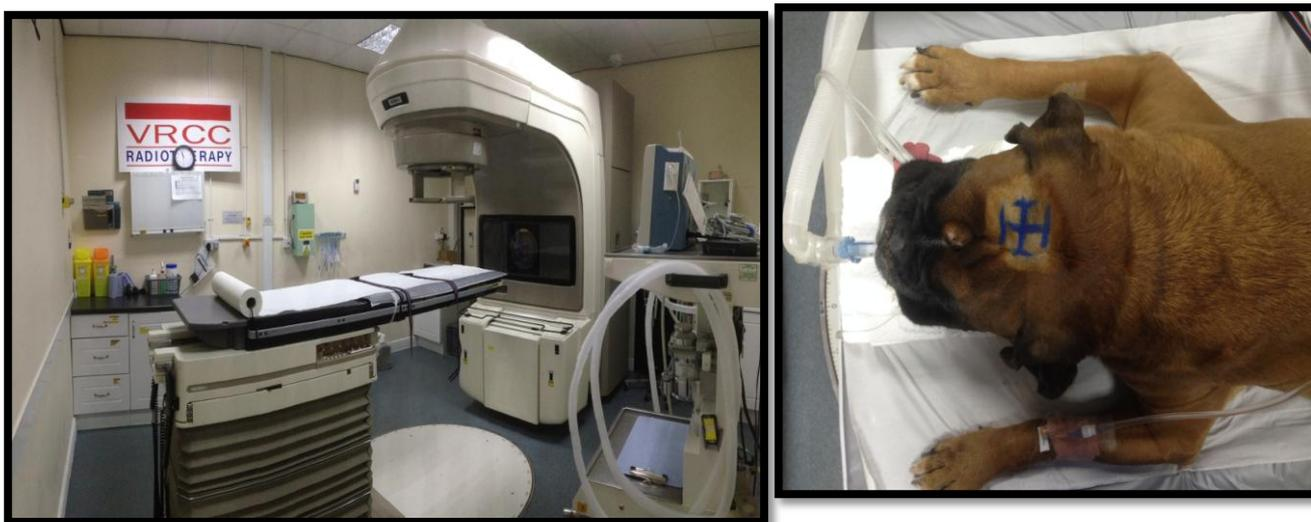
**Figura 3** (à esquerda) - Peça superior do LINAC (*gantry*), responsável pela emissão do feixe de radiação
