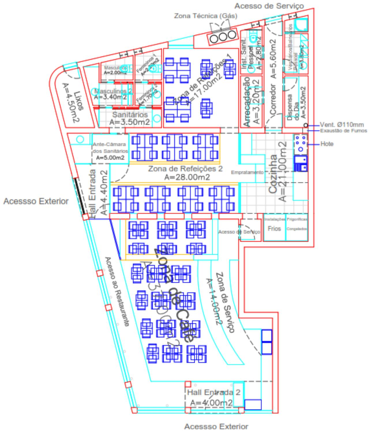
Figura A.1 – Planta do Edifício
