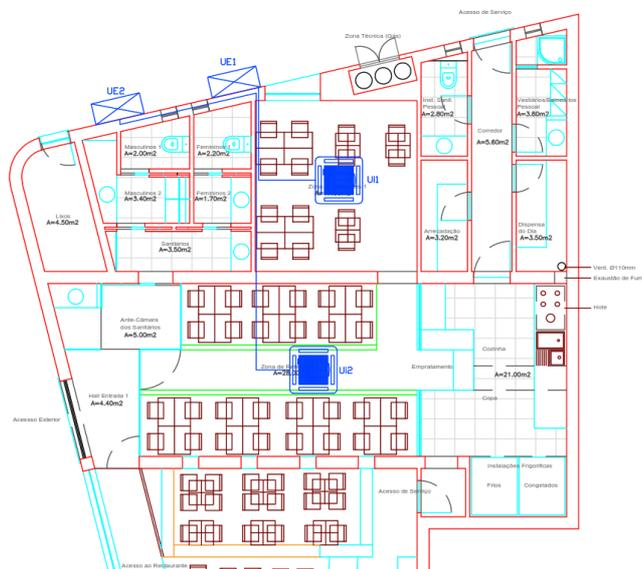
Figura 5.68 – Montagem do sistema monosplit
